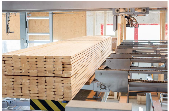
Lames rabotées pour la production de planches juxtaposées. [9]
